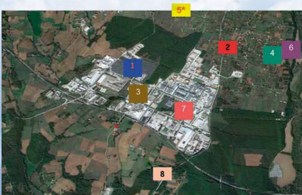
2. Rete degli 8 sensori PID per il monitoraggio in continuo e ad alta risoluzione temporale dei VOC
