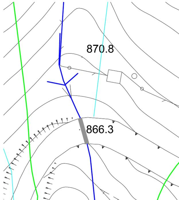
Conosciuta la portata alla sezione 2, è stata verificata la sezione esistente di imbocco del cunicolo in muratura di dimensione 0,90 x 1,30 che attraversa la strada Provinciale 11 bis con percentuale di riempimento del 50 %.
