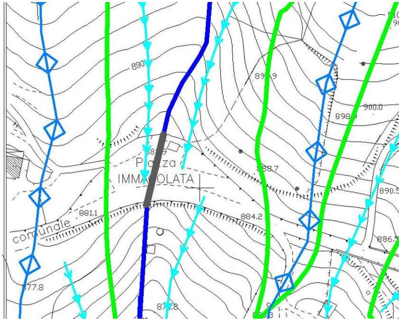
Conosciuta la portata così calcolata è stata verificata la sezione esistente del tubo in acciaio con diametro 1000 mm che attraversa Piazza Immacolata.
