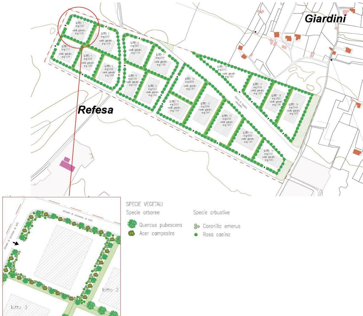
**Figura 1: Planimetria del P.d.L. con evidenziazione delle aree verdi**
