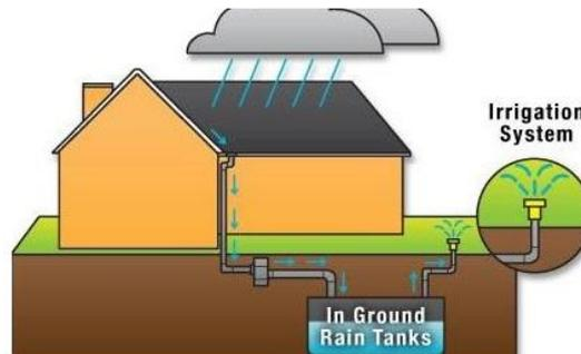
Figura 7: Schema di funzionamento del sistema di recupero dell'acqua piovana
