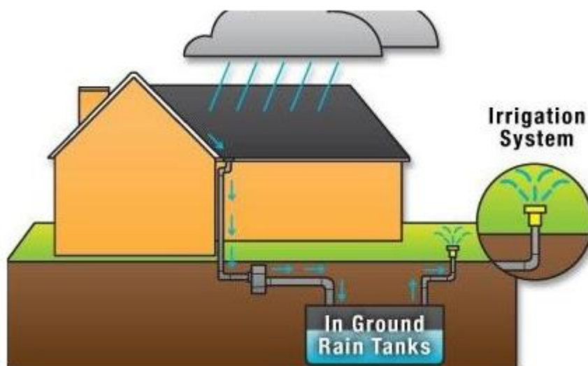
Figura 9 – Schema di funzionamento del sistema di riutilizzo delle acque meteoriche
