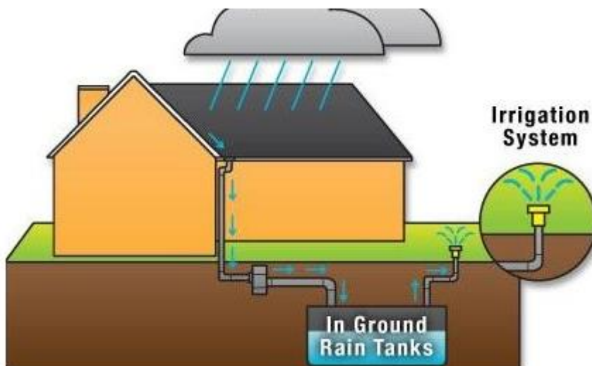
Figura 40 – Schema di funzionamento del sistema di riutilizzo delle acque meteoriche
