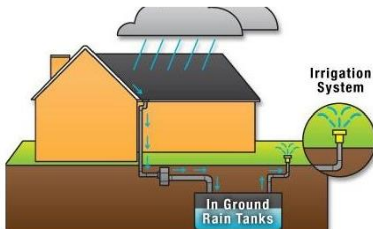
Figura 2 – Schema di funzionamento del sistema di riutilizzo delle acque meteoriche
